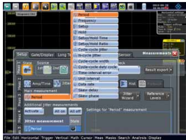
Figur 3. Jittermätningar med jitteranalysalternativen RTO-K12.
