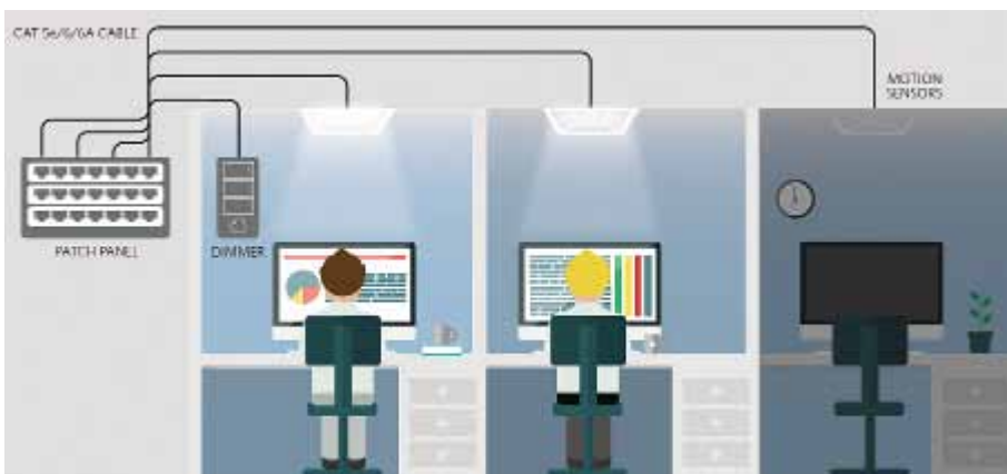
Figur 1. Nätansluten belysning och sensornät kan tillhandahålla nya funktioner överallt där belysningen används och stänga av ljuset när det inte behövs.
